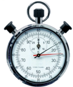
30 mn au 1/5e s et 1/100e mn • 137/2H ▶ Start/Stop par la couronne ▶ Temps intermédiaire/RAZ par poussoirs latéraux ▶ Aiguille rattrapante/dédoublante ▶ Boîtier acier inox / Verre minéral ▶ D : Ø 55 mm / 80x80X25 mm / 130 g
