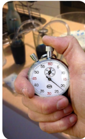
30 mn au 1/5e s et 1/100e mn • 137/2H ▶ Start/Stop par la couronne ▶ Temps intermédiaire/RAZ par poussoirs latéraux ▶ Aiguille rattrapante/dédoublante ▶ Boîtier acier inox / Verre minéral ▶ D : Ø 55 mm / 80x80X25 mm / 130 g
