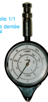
928NP - Boîtier ABS ø 45 mm, manche métal - échelles de mesure Recto : 1/1 - 1/5 000° - 1/20 000° - 1/150 000° Verso : 1 cm = 1 km (1/100 000°) - 1 pouce = 1 mille Mesure les distances réelles (1/1 cm), Grande utilité aux architectes, géomètres Permet la conversion rapide de toutes les échelles
