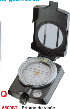
6609ST - Prisme de visée - Capsule rotative Ø 55 mm - Graduation 360° - Préc. 1° / Base 36 - Niveau à bulle - Règle graduée 5 cm - Table de conversion degré, mile, pourcentage / inclinaison, latitude/distance - Flèche lumineuse - Filetage pour fixation trépied - Livrée avec sacoche et cordon - D : 95x60 mm / 240 g
